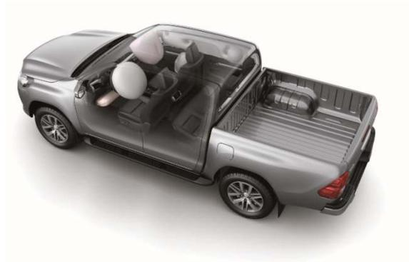
Desde lo estructural, la carrocería no solamente cuenta con barras de protección lateral en las puertas sino que a su vez, fue diseñada para absorber impactos frontales y laterales. Por otro lado, la estructura del chasis fue diseñada para absorber impactos frontales mejorando la absorción de energía respecto de la generación anterior.
